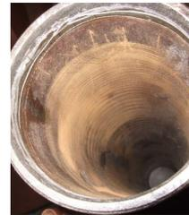
Ein guter Hydraulik- (oder Metallbau-)betrieb kann einen neuen Kolbenkopf drehen, auf den kostengünstige neue Standard-Dichtungen aufgezogen werden können, und im gleichen Zug wurde auch ein neuer Zylinder nach Muster des alten angefertigt:
