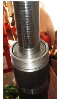
Das Zylinderrohr ist mit einem Dichtring im Fuß eingesetzt – bei Bedarf erneuern!
