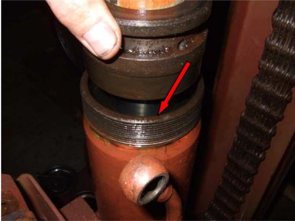
Wenn (wie bei meiner) im Zylinder bis oben Öl steht (Pfeil), zunächst das Öl mit ausreichend langer Schlauchpumpe aus dem Zylinder absaugen.
