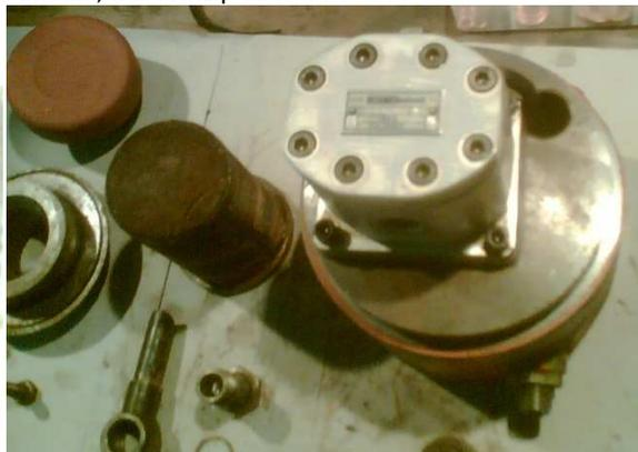
Der Ölbehälter kann und sollte am besten bei ausgebaute Pumpe entleert und gereinigt werden, auch wenn die Bühne erstaunlicherweise selbst dann noch funktioniert, wenn sich im Behälter zu ¼ Schlamm und Wasser befinden
