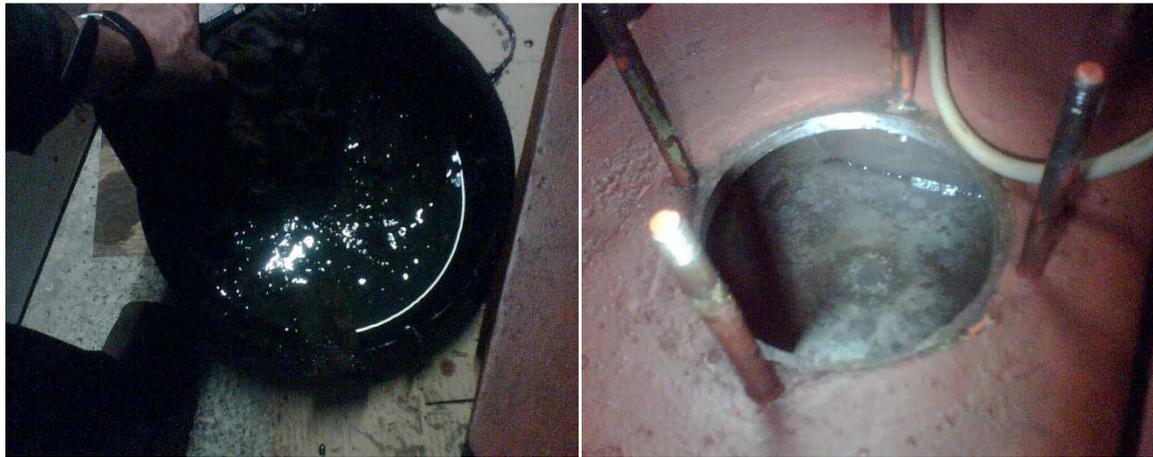
Beim Einbau der Pumpeneinheit den korrekten Sitz der Kupplung beachten und zum Rahmen mit geeignetem Dichtmittel abdichten – unumgänglich, wenn die Bühne im Freien steht!
