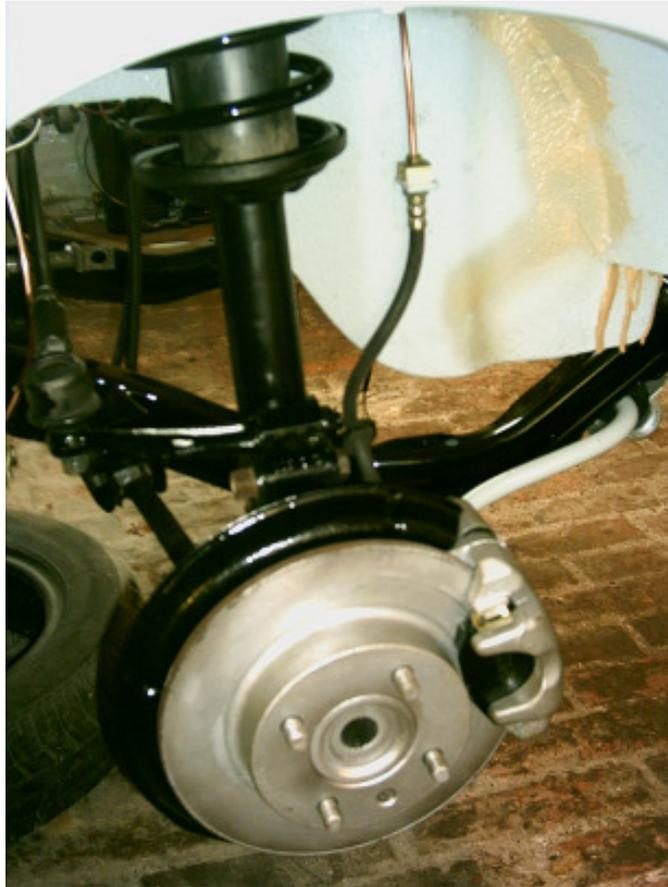
Vorderachse mit McPherson-Federbein, Schwimmsattel-Scheibenbremse und Querstabilisator
