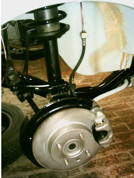
Vorderachse mit McPherson-Federbein, Schwimmsattel-Scheibenbremse und Querstabilisator
