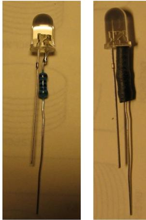
Über den Widerstand schieben wir eine Gummitülle oder etwas Schrumpfschlauch.
