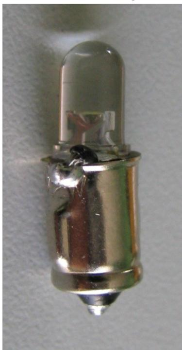
Der aus dem Fußkontakt herausragende Widerstandsdraht wird mit dem kleinen Seitenschneider gekürzt, am Fußkontakt erneut Lötzinn aufgetragen, und der Fußkontakt danach mit Sandpapier oder der kleinen Schlüsselfeile in Form gebracht. Zuletzt wird die Konstruktion mit Hilfe von „UHU-Plus Endfest“ vibrationsfest gemacht in dem wir den Kragen der LED mit der Oberkante der Fassung verkleben in dem der schmale Ritz zwischen LED und Fassung mit Kleber gefüllt wird. (Bild noch ohne Verklebung)
