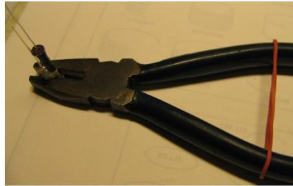
Nun nehmen wir die „entkernte“ Fassung zur Hand und löten eine dünne Litze (wirklich dünn sollte die sein, flexibel, ca.15mm lang, ohne Isolierung reicht!) an dem Punkt an, an dem zuvor auch der „Massetdraht“ der Lampe (außen an der Fassung) angelötet war. Das zweite Ende der Litze kommt später an die Reihe.
